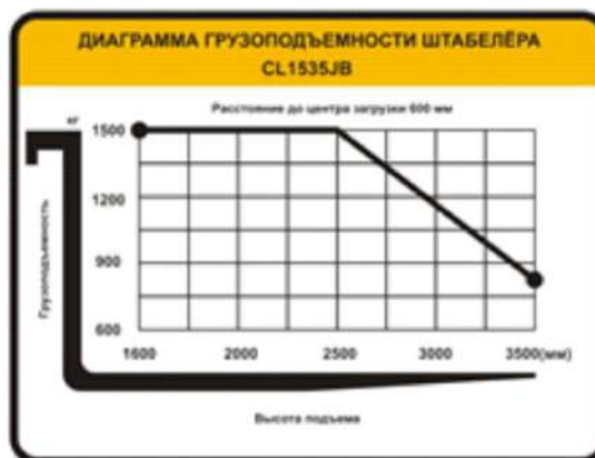
Рисунок 4. Диаграмма грузоподъемности штабелера.
