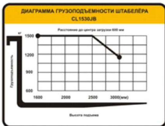
Рисунок 4. Диаграмма грузоподъемности штабелера.
